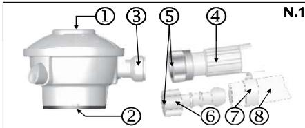
Avant de connecter le Quick-on+ sur la valve de la bouteille, monter le tuyau souple (figure n°1-8) ou le flexible réglementaire (figure n°1-4) sur l'embout (figure n°1-3), du Quick-on+.
