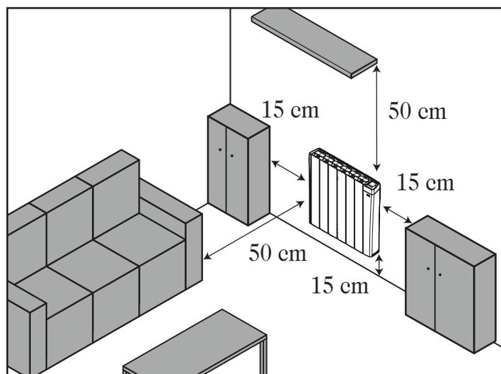
Installation préconisée dans le cadre d'une utilisation de la détection automatique d'ouverture de fenêtre et de la détection de présence/d'absence
