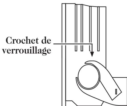
Les sécurités anti-basculement sont en place, le radiateur ne peut plus être décroché du mur sans déverrouillage préalable.
