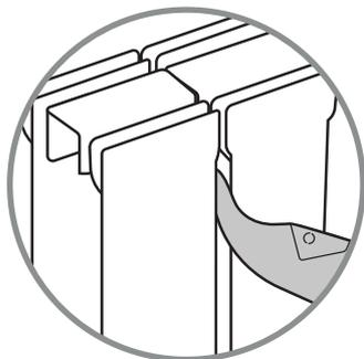
Les consoles de fixation murales sont conçues pour sécuriser l'installation et limiter les mouvements de translation de l'appareil en cas de choc.
