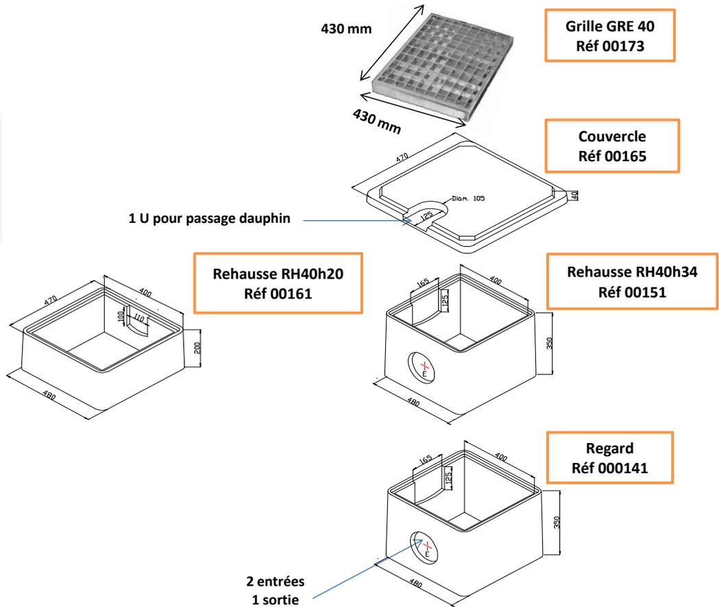
Diamètre de pré-voile en sortie : 180 mm
