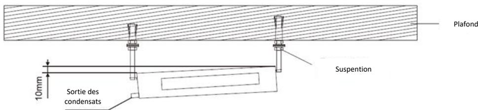
2. Le tuyau des condensats doit avoir une pente descendante (1 / 50-1 / 100). Si le tuyau de vidange est installé avec des contres pentes, cela entraînera un reflux ou une fuite d'eau.
