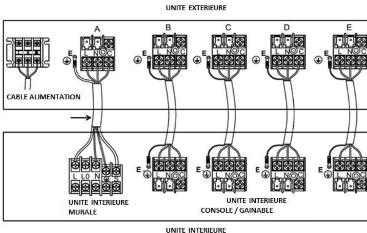
Le câble de raccordement des unités intérieures doit être connecté au bornier correspondant. Sinon, cela provoquerait une panne de l'unité ou même des dégâts matériels.
