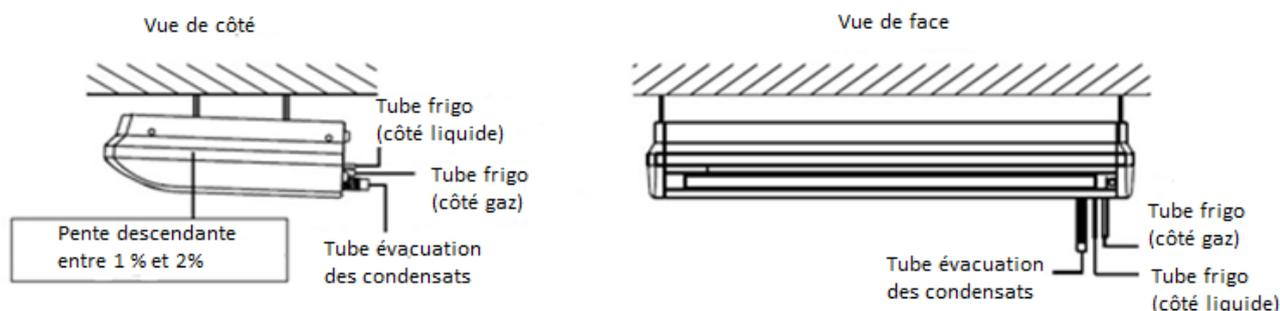
1. Le tuyau de vidange doit être correctement isolé pour éviter la formation de condensation.
