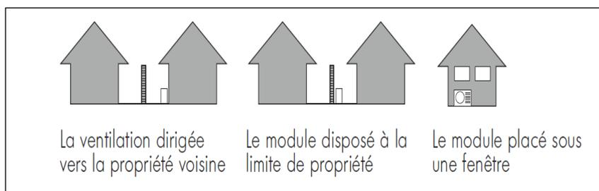
Afin de limiter les nuisances sonores et la transmission des vibrations, nous préconisons :
