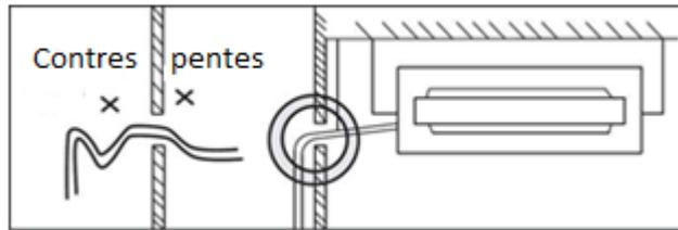
5. L'appareil est équipé d'une pompe de relevage des condensats pouvant pousser jusqu'à 1200 mm.
