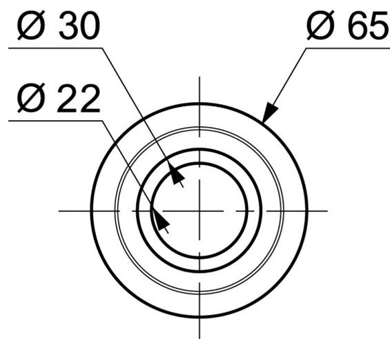
**Joint de clapet standard M25**
