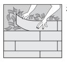
Posez le revêtement sur la colle en suivant les fiches techniques et les recommandations du fabricant. Le dos des dalles doit être enduit de colle. En cas de doute, soulevez la dalle pour vérifier.
