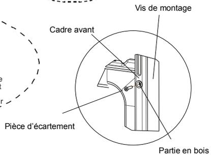
Insérez le four dans le cabinet en le poussant vers l'avant. Ouvrez la porte du four et ajoutez 2 vis dans les trous situés sur le cadre four. Bien que le produit touche le cadre en bois surface de cabinet, serrez la vis.
