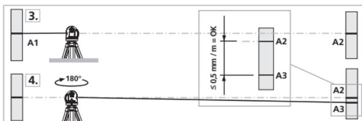
**!** Se os pontos A2 e A3 estiverem separados mais de 0,5 mm / m é necessário efectuar uma calibragem. Contacte o seu distribuidor ou dirija-se ao departamento de assistência da UMAREX-LASERLINER.
