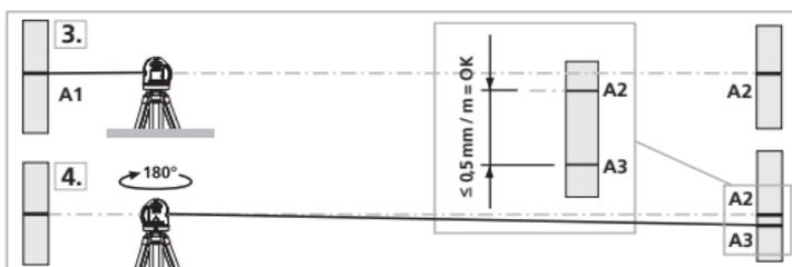
**!** Si los puntos A2 y A3 están separados más de 0,5 mm / m, es necesario efectuar una calibración. Póngase en contacto con su distribuidor especializado o diríjase al Servicio Técnico de UMAREX-LASERLINER.
