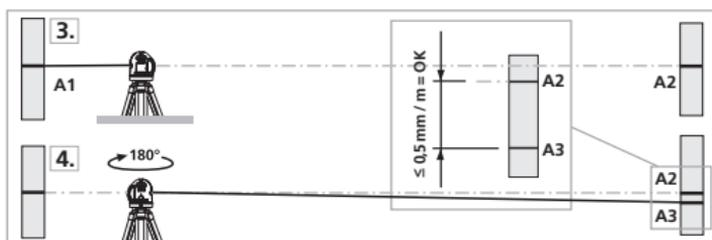
**!** Dacă A2 și A3 se află la o distanță mai mare de 0,5 mm / m, trebuie efectuată o calibrare. Contactați un comerciant specializat și adresați-vă departamentului service UMAREX-LASERLINER.
