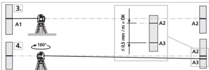
! Laite on kalibroitava, jos pisteiden A2 ja A3 välinen erotus on suurempi kuin 0,5 mm / m. Ota yhteys paikalliseen laitetoimittajaan tai UMAREX-LASERLINER huolto-osastoon.
