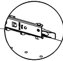
Mettre le levier de fixation en position ouvert pour sécuriser le système d'ancrage de votre attache murale.
