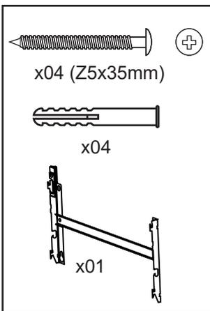
Les vis et chevilles fournies sont adaptées pour des supports de type plein. Pour tout autre type de support, veuillez utiliser les vis et chevilles adaptées.
