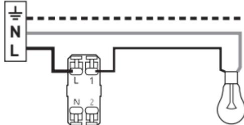
En va-et-vient, commande de 2 endroits différents
