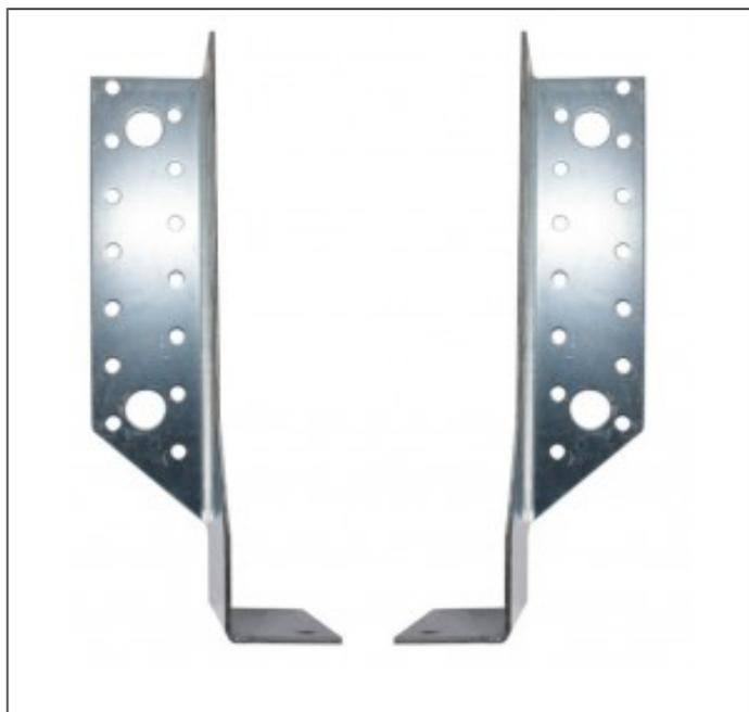
Les sabots deux éléments SDE permettent de s'adapter à des sections de bois dont la largeur est comprise entre 60 et 120 mm. La mise en oeuvre des pointes dans la base du sabot est impérative pour assurer un bon assemblage.
