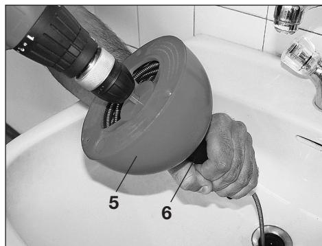
**Certifique-se de que a broca está desligada do adaptador hexagonal quando a bobina de limpeza estiver a ser puxada de volta para o invólucro de plástico.**
