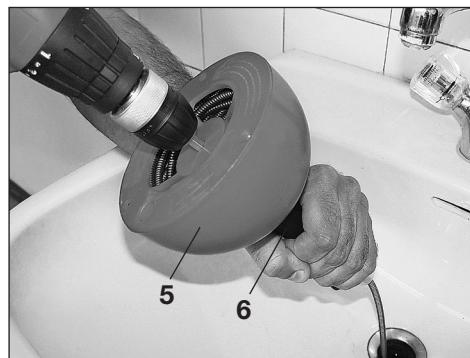
**Se till att borrmaskinen är frånkopplad från sexkantsadaptern när rengöringsspiralen dras tillbaka in i plasthöljet.**
