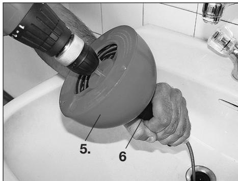
**Assurez-vous que la perceuse est débranchée l'adaptateur hexagonal lorsque la bobine de nettoyage est tirée en arrière dans le boîtier.**
