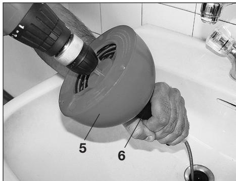
**Ko navijate spiralno žico za čiščenje nazaj v ohišje, mora biti vrtalnik odklopljen s šestkotnega nastavka.**
