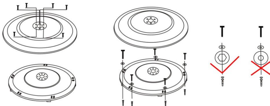
Fixer le tube du bas à l'aide de 6 pcs de vis M6X35 MM, posez ensuite le couvercle décorative sur le tube pour cacher les vis.
