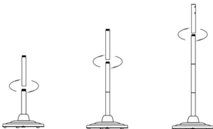
Connectez le tube du haut avec le chauffage en utilisant les vis M4X10 :
