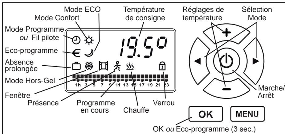
L'icône et la valeur de la fonction en cours de réglage clignotent. Le clignotement s'arrête quand le réglage est validé par la touche **OK** ou après 30 secondes d'inaction (la modification du réglage est alors annulée).
