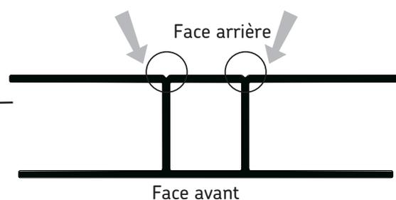
Poussez le profilé en H sur le panneau 2 et vers le bas sur le bloc inférieur central. Notez que la face avant est plus courte que la face arrière.
