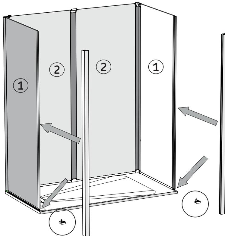
**i.** Faites glisser les deux blocs d'angle avant sur le receveur par-dessus les panneaux 1 pour les fixer correctement.
