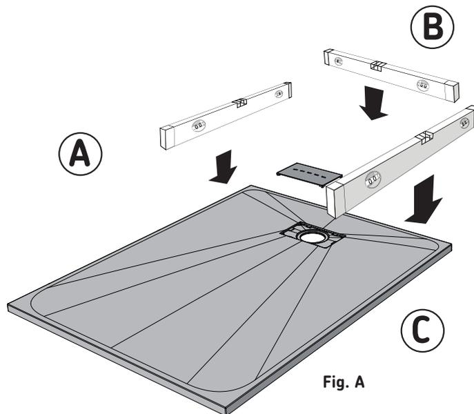
**IMPORTANT:** Avant de terminer l'installation du receveur, testez le débit d'eau du receveur dans la bonde.
