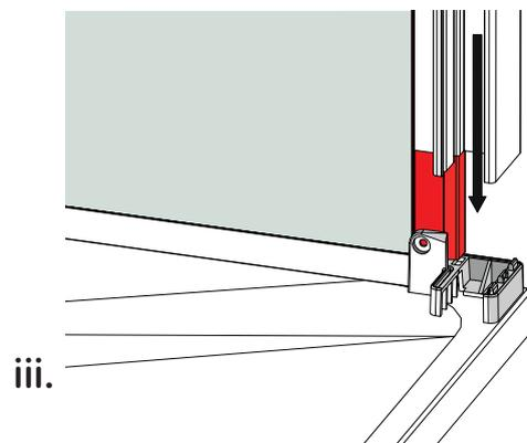
12 Installer les blocs d'angle supérieur
