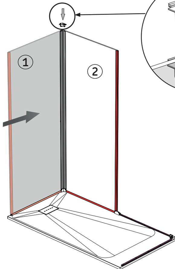
Installez le panneau 1 sur le cadre du receveur dans le profilé d'angle. Assurez-vous que les panneaux 1 et 2 soient correctement insérés et ajustés au bloc d'angle supérieur afin de maintenir les deux panneaux ensemble.
