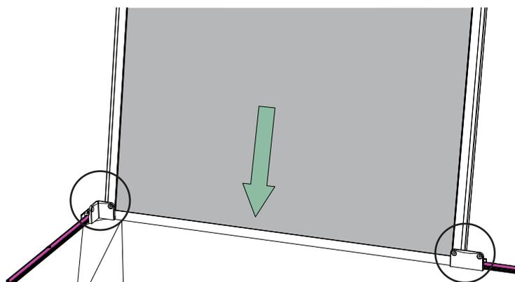
Installer tous les panneaux et pièces de finition avant de percer.
