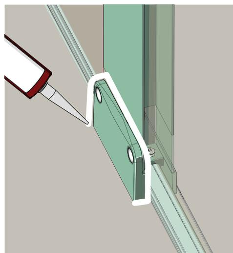
Siliconez autour pièces d'angles et de finition sur le receveur.
