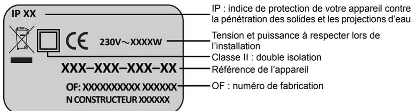
Le raccordement au réseau électrique doit être effectué en respectant :
