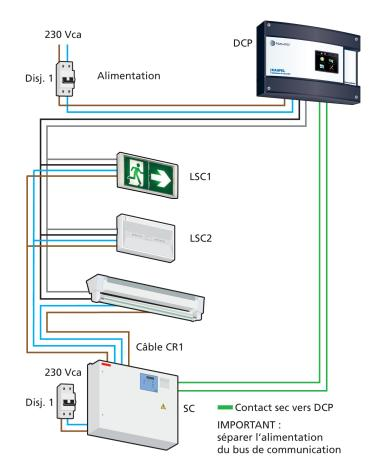
Alimentation réseau 230 VCA 50Hz -> Câble de type C2 non propagateur de flamme.
