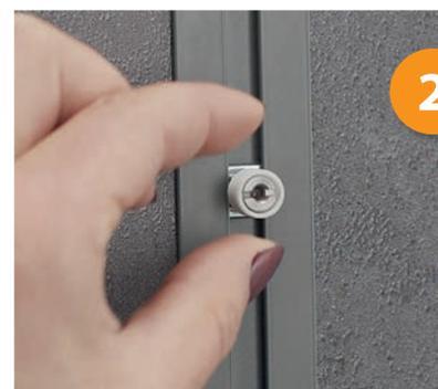
**Positionner le set de fixation sans perçage dans le profilé de réception**
