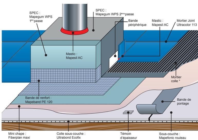
**Fig 10 : Traitement d'une traversée de canalisation sur support bois avec réalisation d'un socle**
