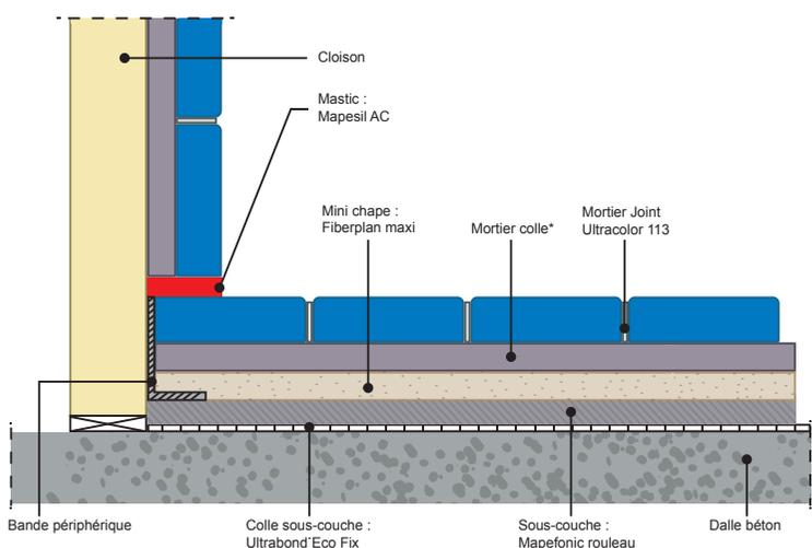
Fig 2 (bis) : Traitement de la jonction sol/mur avec relevé de la sous-couche
