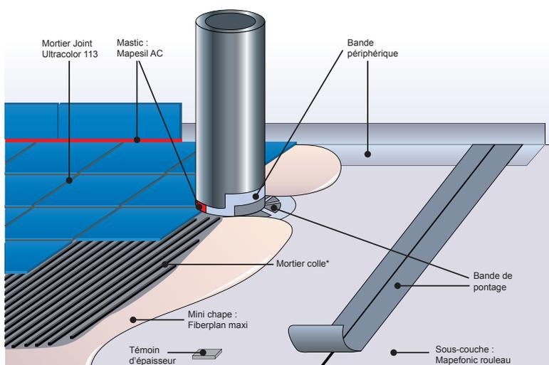
**Fig 9 : Traitement d'une traversée de canalisation**
