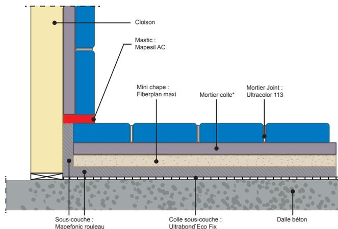
Fig 2 : Traitement de la jonction sol/mur avec la bande périphérique
