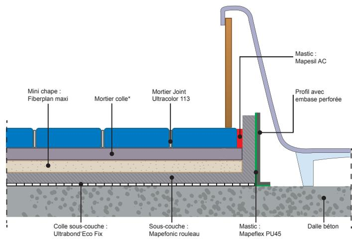
**Fig 7 (bis) : Pose de baignoire sur support maçonné : cas d'une allège amovible**
