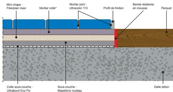
Figure 5 : Traitement des seuils : cas d'un parquet dans le local adjacent
