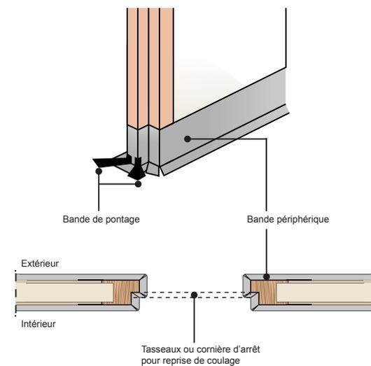
Fig 3 : Traitement des huisseries et des seuils de porte
