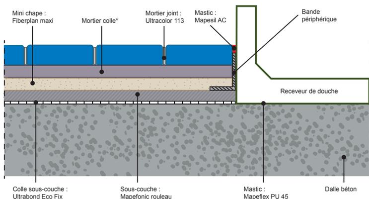
Fig 1 : Traitement de la jonction avec un receveur de douche posé sur le support maçonné
