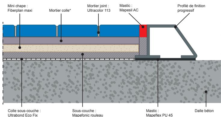
Fig 4 : Traitement des seuils de porte : cas d'un revêtement de sols souples dans le local adjacent
