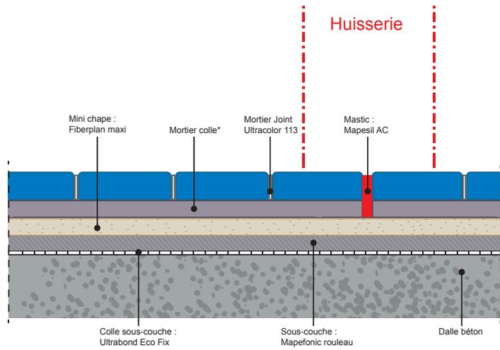
**Fig 6 : Traitement des seuils : cas d'un carrelage dans le local adjacent**
