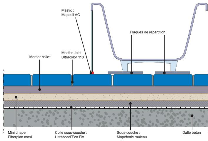
**Fig 7 : Pose de baignoire avec une allège amovible sur le revêtement céramique**
