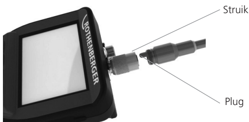
Figuur 2 - Kabelverbindingen (connectorstijl A, zwarte kleur)
