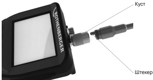
Рисунок 2 - подсоединение кабеля (Разъем типа А, черный)
