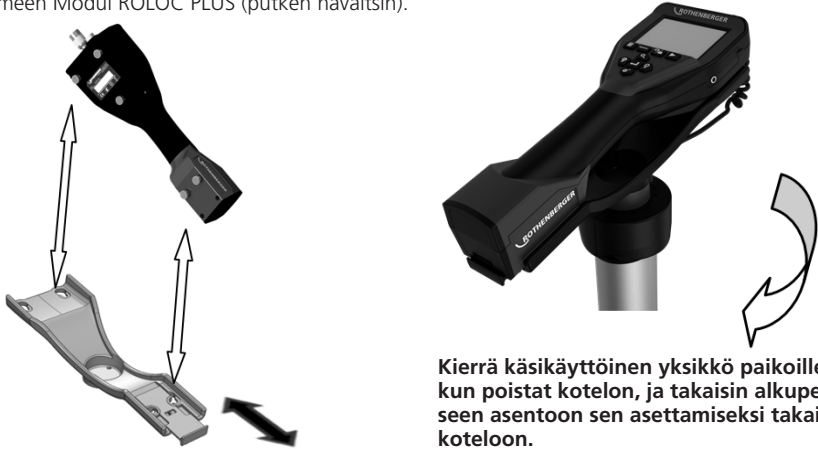
Kuva 4 - Miten käsiyksikkö ROSCOPE 1000/i2000 asetetaan pidikkeeseen
