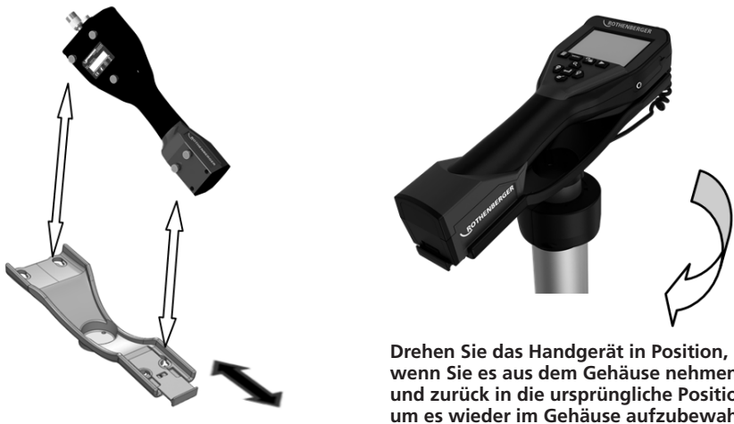
Bild 4 - Installation ROSCOPE 1000/i2000 Handgerät.
