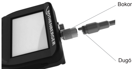
2. ábra - Kábel csatlakozások (A típusú csatlakoz, fekete színű)
