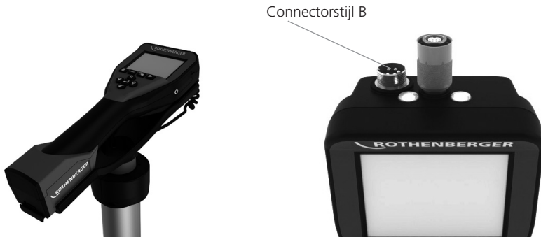
Figuur 3- Kabelverbindingen (connectorstijl B, zilveren kleur)
