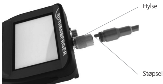
Figur 2 - Kabelkontakter (kontakt type A, svart)
