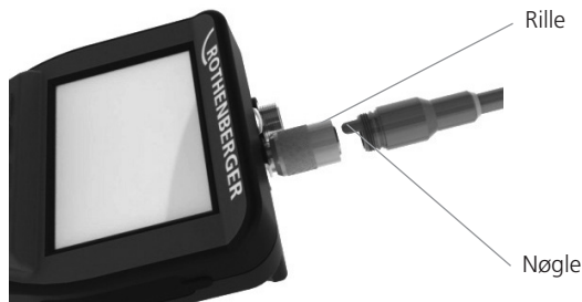
Figur 2 - Kabeltilslutninger (stikforbindelse stil A, sort farve)
