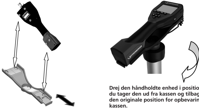
Figur 4 - Installation af ROSCOPE 1000/i2000 håndholdt enhed på monteringsstativ
