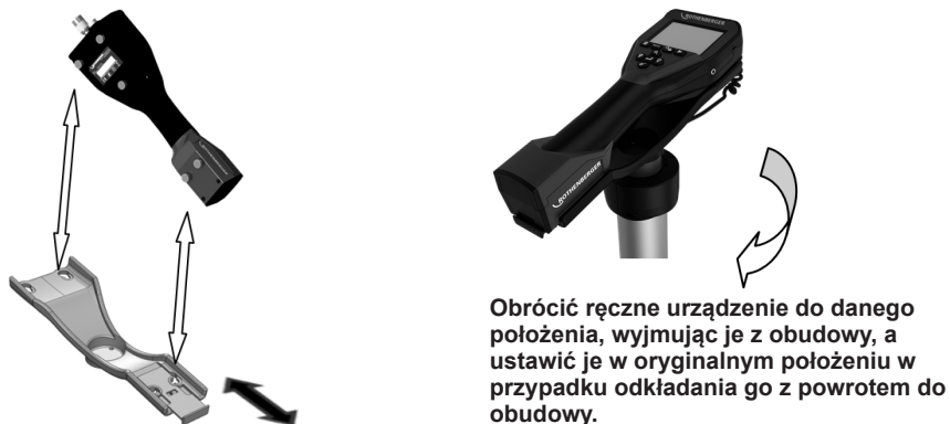
Rysunek 4 - Instalowanie ręcznej kamery ROSCOPE 1000/i2000 w podstawie montażowej
