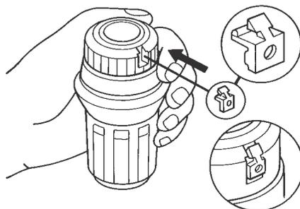
Une fois que la tête thermostatique est montée sur le robinet, appuyez sur le dispositif de protection antivol. Ainsi, la tête thermostatique ne peut plus être retirée.
