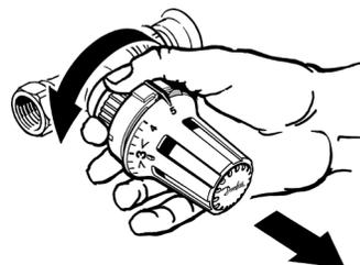
Après un démontage, on réarme le mécanisme en tournant la bague dans le sens anti-horaire.
