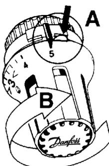
Grâce aux deux boutons de limitation intégrés, le réglage de la température peut être limité (voir les schémas ci-dessus et à gauche).
