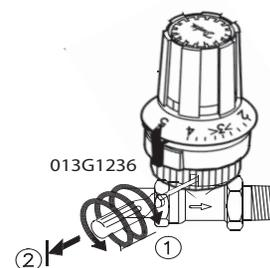
Pour retirer la protection antivol, utilisez un tournevis 013G1236 et desserrez la vis dans le trou (1). Dévissez jusqu'à la butée d'arrêt (2). Il est à présent possible de dégager la tête du robinet.
