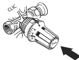
Le circlip fixe automatiquement la tête sur le corps. Le mécanisme d'emboîtement est actif d'origine et est prêt au montage.
