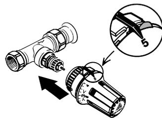
Le montage de la tête sur le corps de robinet est très simple et s'effectue sans outils. Placez la tête sur le corps et exercez une pression jusqu'à ce qu'il s'emboîte sur la vanne.
