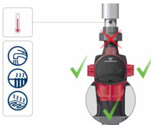
Fig. 3 Positions du coffret de commande, installations de chauffage et d'eau chaude sanitaire
