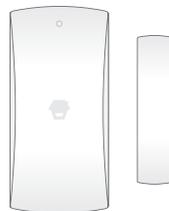
Si vous choisissez de fixer ce détecteur à l'aide de vis, vous devrez ouvrir les deux boîtiers. Veillez donc à ne pas retirer les languettes de protection des piles avant cette opération car le détecteur est équipé d'un contact anti-sabotage. Ce contact envoie directement un déclenchement d'alarme à la centrale lorsque le boîtier est ouvert.
