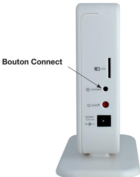
**a.** Appuyez sur le bouton connect à l'aide d'un stylo ou d'un objet pointu. Le voyant passe alors au rouge.
