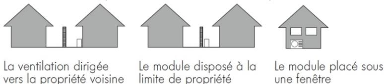
Afin de limiter les nuisances sonores et la transmission des vibrations, nous préconisons :
