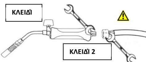
**Όταν χρησιμοποιείται βουτάνιο,** συνδέστε το λάστιχο στη βαλβίδα του κυλίνδρου. ΠΡΟΕΙΔΟΠΟΙΗΣΗ: ελέγχετε τη στεγανότητα μεταξύ του εξαρτήματος του λαστίχου και της βαλβίδας του κυλίνδρου. Η πίεση δεν πρέπει να υπερβαίνει τα 3bar.
