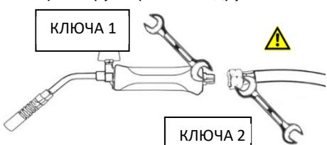
**При использовании бутана**, соедините шланг с клапаном цилиндра. Предупреждение: проверьте закрепленность между штуцером шланга и клапаном цилиндра. Давление не должно превышать 3 бар.
