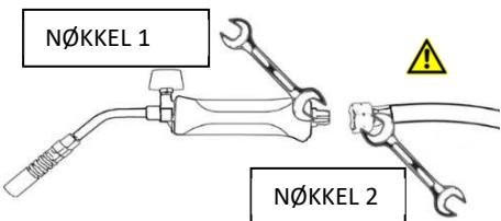
**Ved bruk av Butan**, koble slangen direkte til flaskeventilen.
