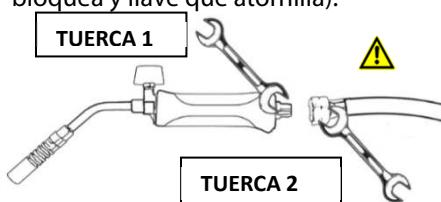
**Cuando se utiliza butano**, conecte la manguera a la válvula del cilindro.
