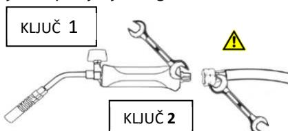
**Pri uporabi butana**, priključite cev na ventil jeklenke.
