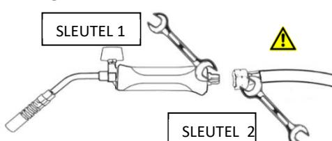
**Wanneer butaan wordt gebruikt**, sluit u de slang aan op het cilinderventiel.
