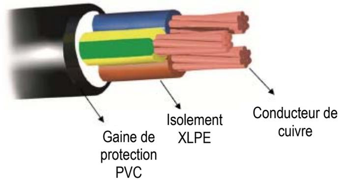
*Câbles multipolaires de 2 à 5 conducteurs avec section nominale 1,5 / 2,5 / 4 / 6 et 16 mm<sup>2</sup>.*
