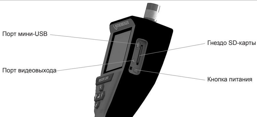
Рисунок 14 – Подключение USB для передачи
