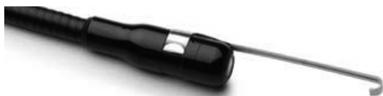
Εικόνα 9 – Εγκατάσταση ενός αξεσουάρ στη μονάδα απεικόνισης με σύνδεσμο τύπου “Α”
