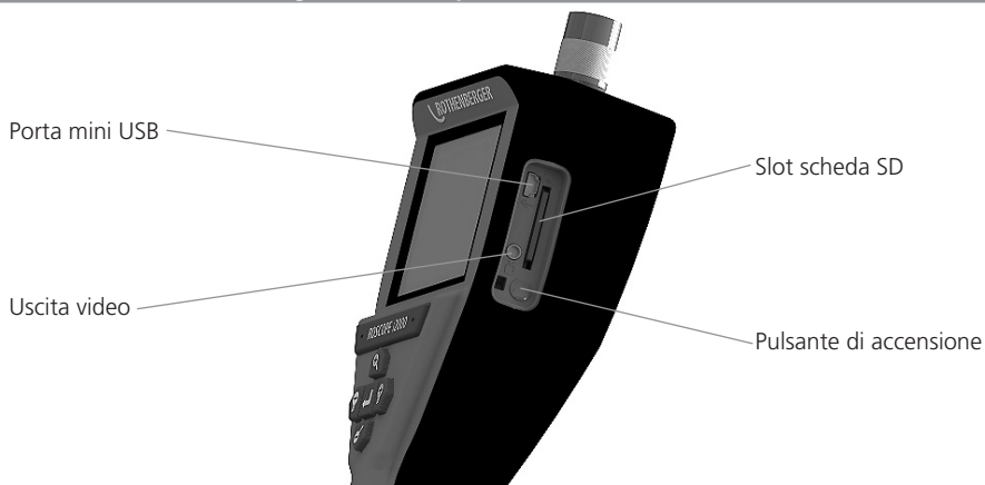
Figura 14 – Connessione USB per il trasferimento
