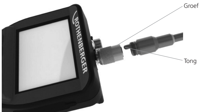
Afbeelding 6 - Kabelaansluitingen (connector type „A“, zwarte 9-pin connector)
