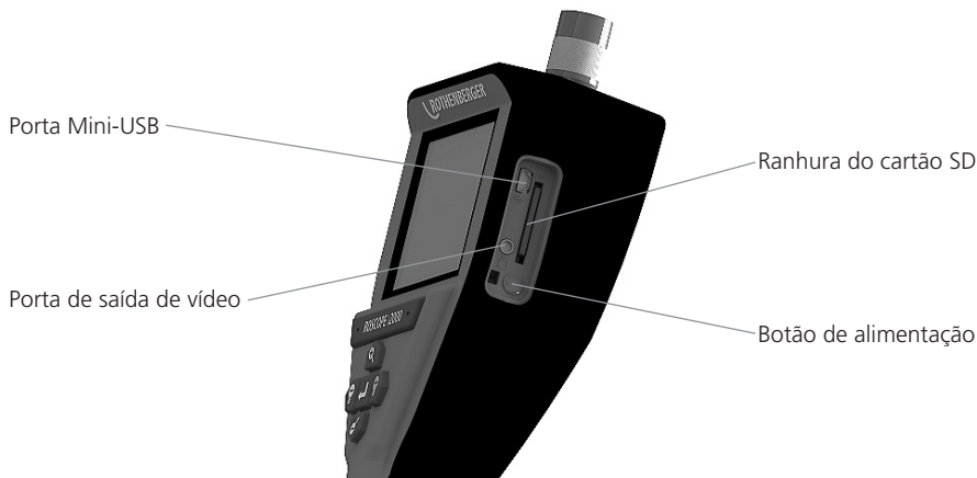
Figura N.º 14 – Ligação USB para transferência
