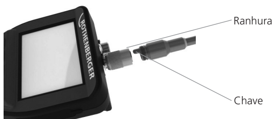
Figura 6 - Ligações dos cabos (conector estilo "A", conector estilo 9 pinos, preto)
