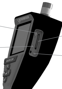
Afbeelding 14 – USB-aansluiting voor overdracht
