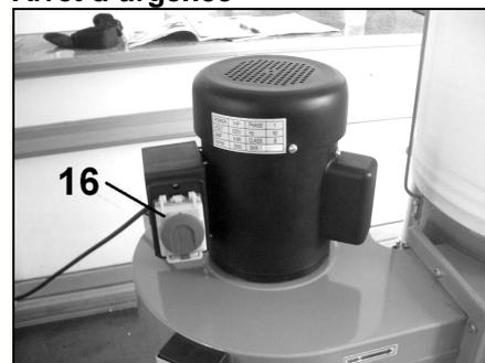
L'interrupteur marche/arrêt de la machine est équipé d'un couvercle "arrêt coup de poing" d'urgence (16). La fermeture de ce couvercle par une simple frappe provoque l'arrêt instantané de la machine. Restez vigilant et soyez prêt à actionner l'arrêt coup de poing en cas de danger ou de problème.
