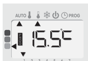
Fil pilote = Éco Confort - 3,5°C
