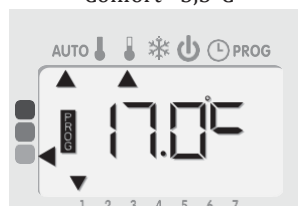
Fil pilote = Éco - 2 Confort - 2°C
