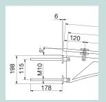
1 / Repérer les cotes de perçage. Vérifier le niveau et marquer au crayon les trous de perçage.
