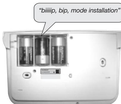
A la mise en place des piles, la centrale se trouve automatiquement en mode installation.
