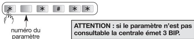
• **programmer** un paramètre, composer la "séquence de paramétrage" détaillée dans le chapitre *Programmation* :
