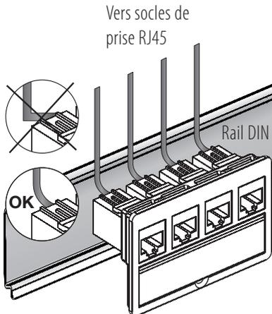
3. Vérifiez la continuité des circuits RJ45 entre le coffret de communication et les socles de prise à l'aide d'un testeur de continuité.
