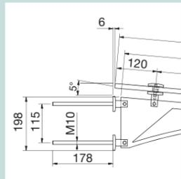
1 / Repérer les cotes de perçage. Vérifier le niveau et marquer au crayon les trous de perçage.
