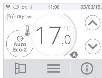
Fil pilote = Éco - 2 Confort - 2°C
