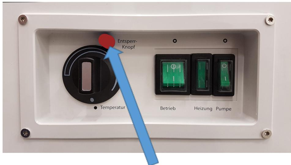
Im Falle eines Defektes, löst das Sicherungselement aus.
