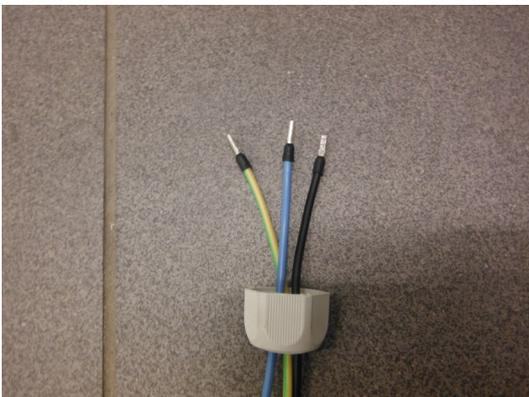
Kabel in das Gehäuse einsetzen.
