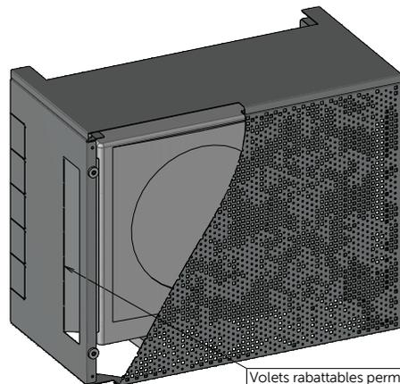
Volets rabattables permettant un ajustement au plus près du groupe extérieur de ventilation pour minimiser les phénomènes de recirculation d'air
