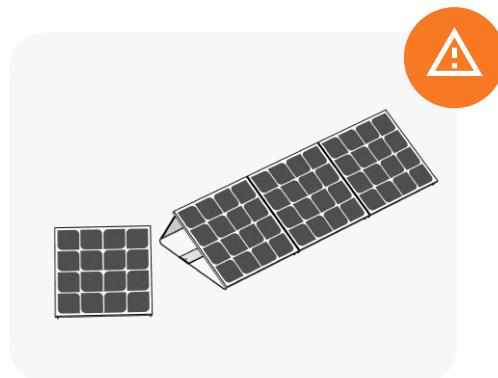
Ne pas orienter les modules d'un même kit dans différentes directions
