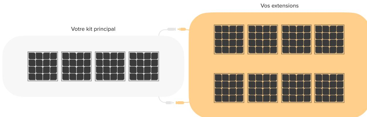
Vous pouvez brancher jusqu'à 3 kits sur la même Beembox et sur le même circuit électrique.
