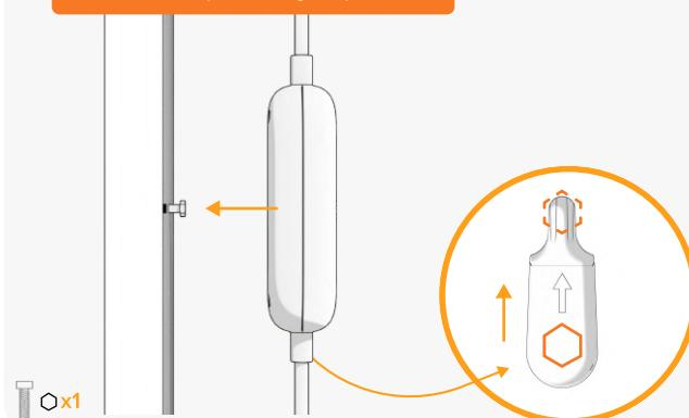
8. Visser la "vis Beembox" au mur. Faire glisser la Beembox sur la vis, à l'horizontale ou à la verticale pour la clipser.
